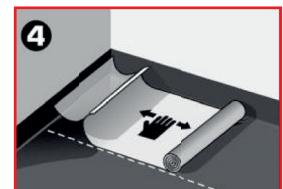
Αποκολλάμε και τραβάμε το Αντικολλητικό Φιλμ και ενώ ταυτόχρονα ξετυλίγεται και κολλάει το TECHNOELAST FLOOR προσέχουμε να μην αφήνουμε φουσκάλες με αέρα και το πατάμε σε όλη την επιφάνεια
